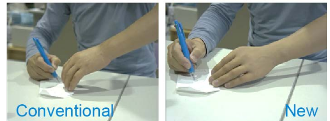
図2 ソフトソケットと指関節のバネ機構によって実現される義手の自然なふるまい
