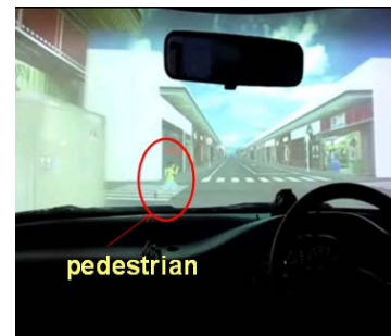
図3 運転シミュレータを用いた歩行者飛び出し再現
