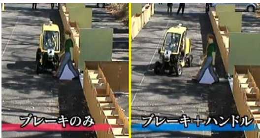
図1 歩行者衝突回避実験(制動回避と操舵回避)
